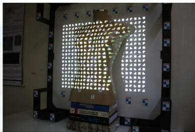
As fotografias utilizadas, obtidas visando a placa de calibração do LAFOTO, tiveram os pontos fotogramétricos necessários – pontos de controle, com coordenadas conhecidas – obtidos no programa MID.
