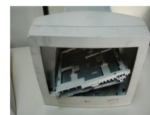
Fig. 3 – Carcaça externa polimérica
