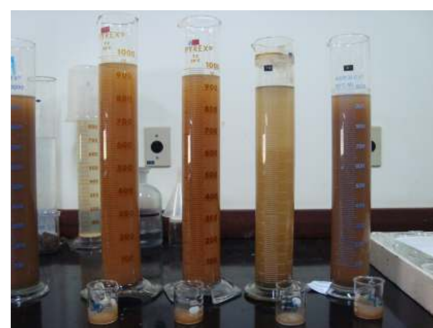
Fig.08 - Método de pipetagem das amostras.
