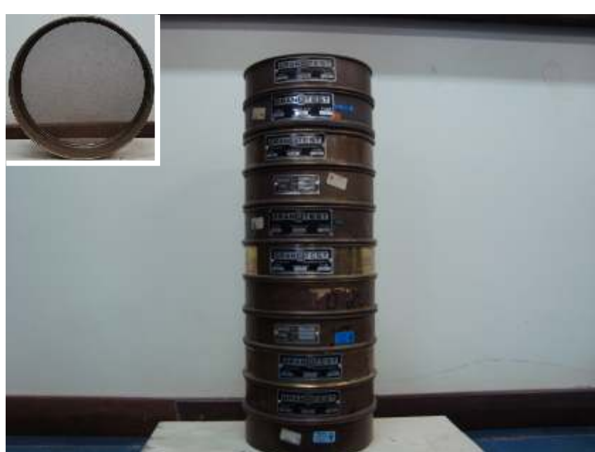
Fig.07 - Método de peneiragem das amostras.
