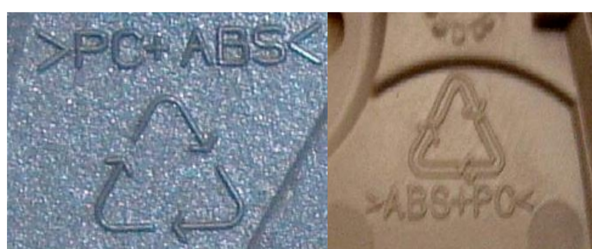
FIGURA 2: Identificação dos polímeros das carcaças dos aparelhos de telefone celular
