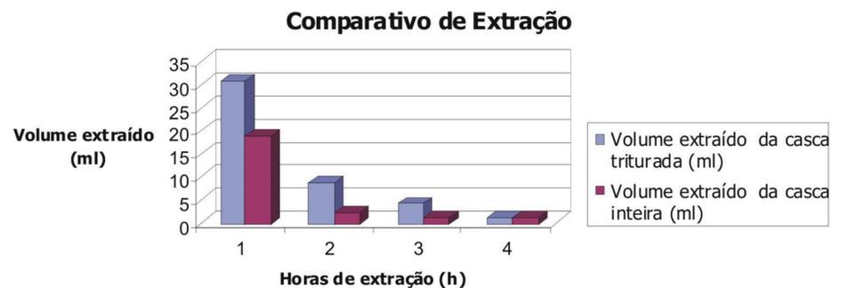
Analisando a figura pode-se verificar que 68% (para amostras trituradas) e 81% (para amostras inteiras) do óleo é extraído na primeira hora do processo.
