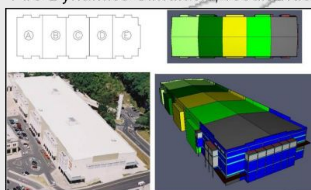
À esquerda: esquema da modulação da edificação real e foto da mesma. À direita: representação da edificação no software de simulação.
