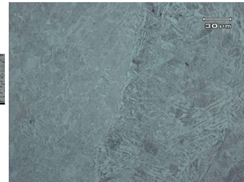
Figura 4. Interface pino/metal base, amostra SAE 8620 (300 kN) apresentando ferrita Widmanstätten e martensita. (500x).
