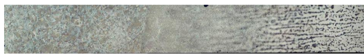
Figura 5. Transição microestrutural da amostra ASTM A36 (300kN), a partir do metal base em direção ao pino, de ferrita e perlita → perlita degenerada → martensita/ferrita. (100x).
