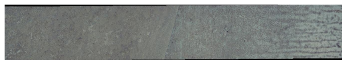
Figura 3. Transição microestrutural da amostra SAE 8620 (300 kN), a partir do metal base em direção ao pino, de ferrita e perlita → perlita degenerada → martensita/ferrita. (100x).
