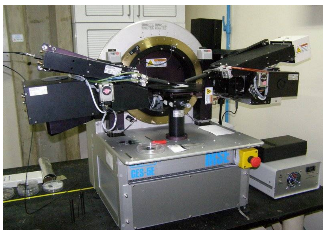
Fig.1 Foto do Elipsômetro Espectral SOPRA.
