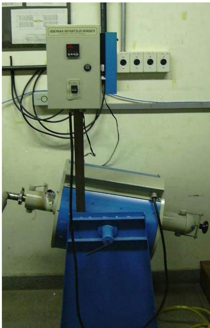
Figura 3.4 – Forno de resistência de Kantal utilizado para brasagem reativa convencional.
