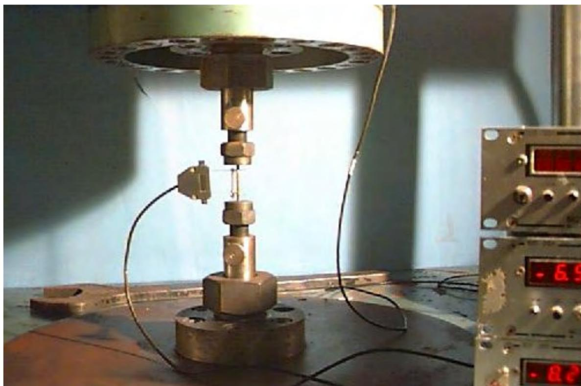
Figura 4.1- Arranjo experimental para ensaios de tração do filme de diamante e metal duro brasados. No primeiro plano está o sistema de aquisição de dados, e ao fundo, o par de garras e um corpo de prova montado.
