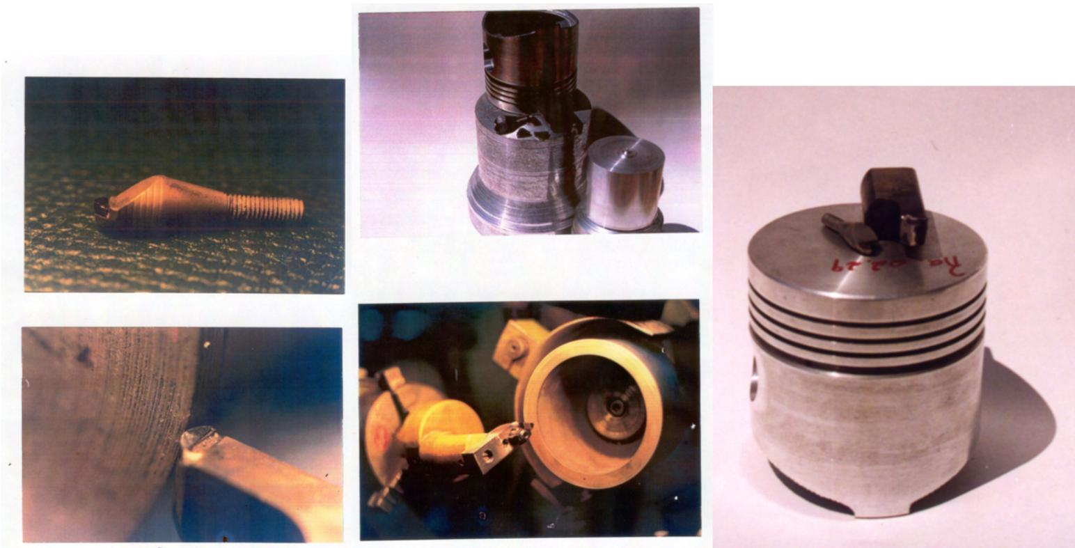
Figura A.2- Tipos de ferramentas com insertos de filmes de diamante brasados da forma convencional em base de metal duro com diversas geometrias e raios de quina para tornear Al e ligas AlSi, grafite, fibra de vidro. Estas ferramentas foram fabricadas e testadas durante o desenvolvimento deste trabalho.
