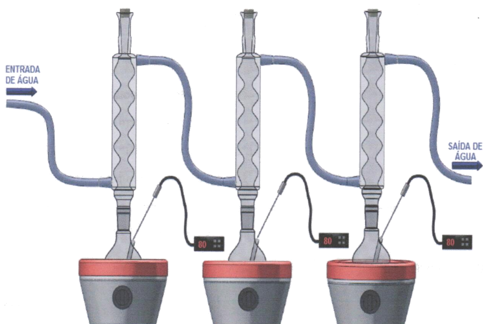
Figura 1. Montagem do sistema de refluxo simulando meio intra-oral contendo agentes corantes.
