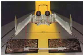
Fig. 01 - Estereoscópio de espelhos. Instrumento clássico de análise e interpretação de fotografias aéreas.
