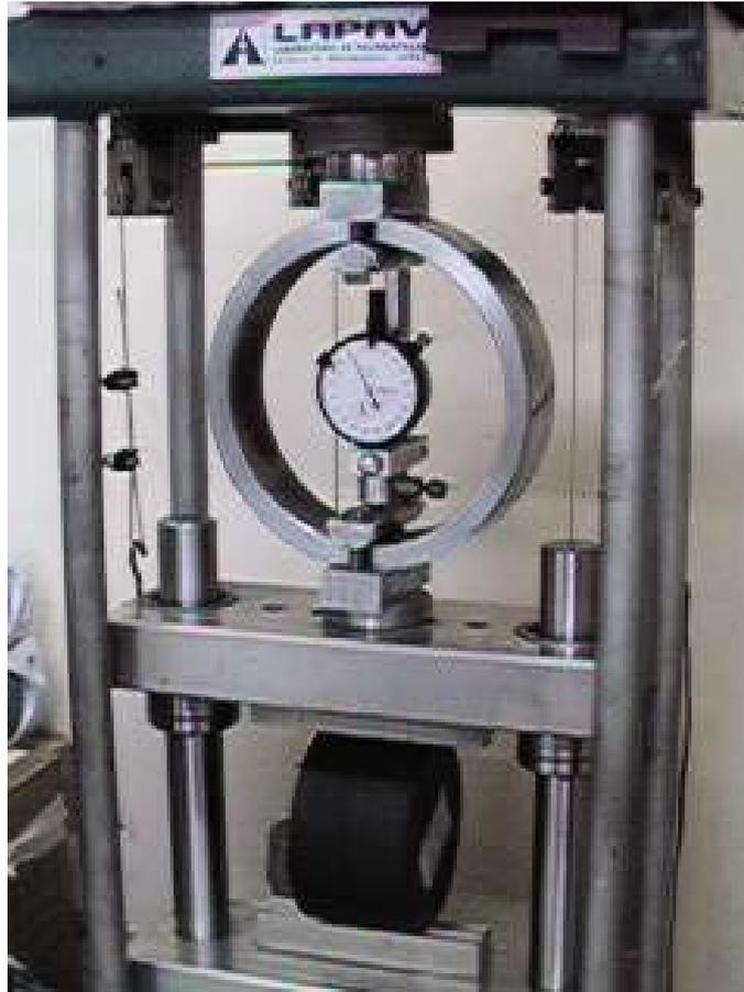
Figura 3.23 – Ensaio de Resistência à tração por Compressão Diametral
