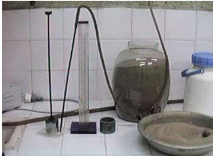
Figura 3.15- Equipamentos utilizados no ensaio de Equivalente de Areia.
