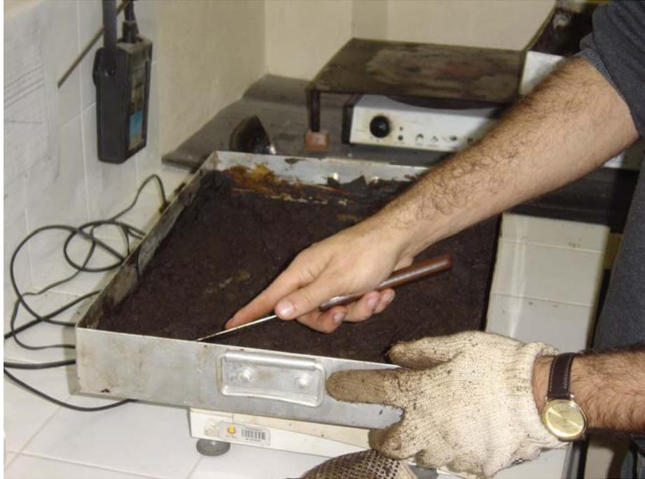
Figura 4.8- Mistura de areia-asfalto a frio
