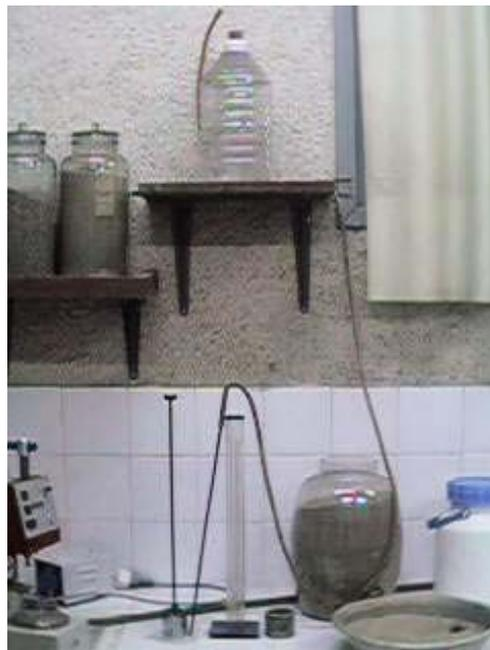
Figura 3.16- Altura de queda 90 cm. Equivalente de Areia.
