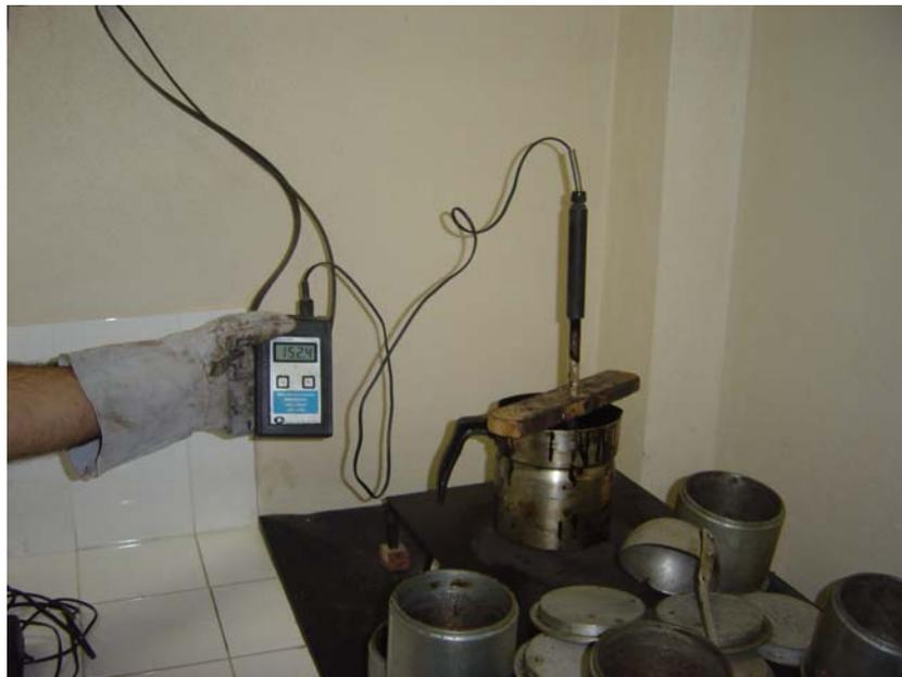
Figura 3.19- controle de temperatura do Ligante
