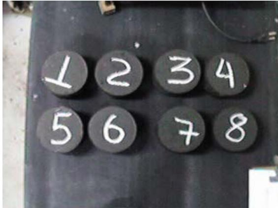
Figura 4.16- Corpos-de-prova para ensaio Cantabro.
