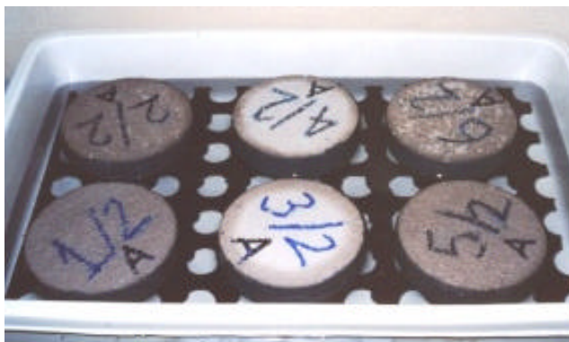
Figura 17: corpos-de-prova durante o ensaio de absorção capilar de água
