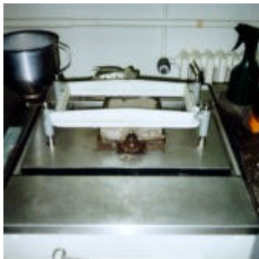
Figura 40: adensamento dos corpos-de-prova com o uso de mesa vibratória
