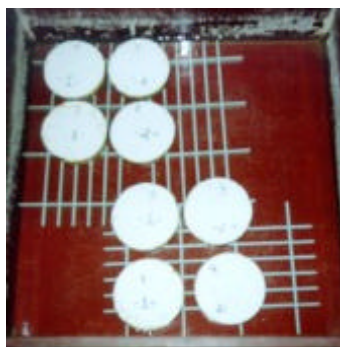
Figura 42: corpos-de-prova de argamassa durante o ensaio de absorção de água por capilaridade
