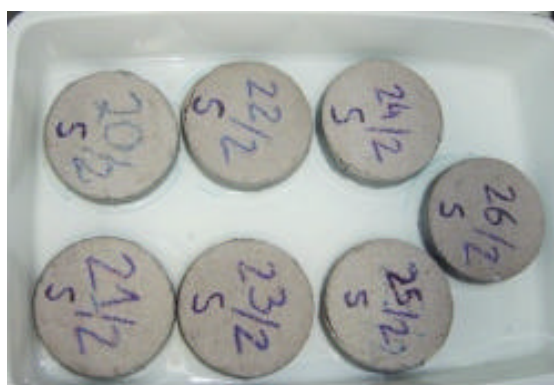
Figura 19: ensaio de resistência aos sais em corpos-de-prova de argamassa
