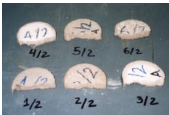
Figura 18: corpos-de-prova cilíndricos preparados para a medição da profundidade de penetração de água por capilaridade
