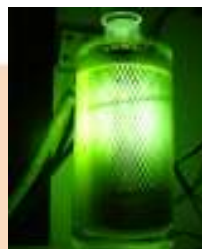
Figura 4: Reator utilizado nos ensaios de EL e FEO. Onde: 1) reator de vidro encamisado, 2) ânodo - Ti/Ru_{0,3}Ti_{0,7}O_2 , 3) cátodo - Ti/TiO_2 , 4) tubo de quartzo, 5) lâmpada de vapor de mercúrio de 250 W. As setas indicam a entrada e a saída do banho de refrigeração.
