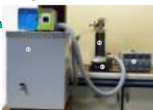
Figura 3: Aparato experimental. Onde: 1) banho ultratermostático, 2) reator de vidro, 3) agitador magnético e 4) fonte de corrente.
