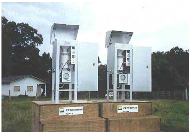
Figura 5: Amostradores HI-VOL - PTS, para coleta de partículas totais em suspensão atmosférica.
