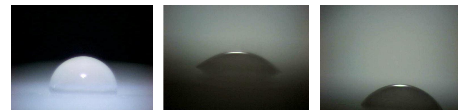
Figura 5: Fotos da variação do WCA do PEBD nos tempos de 0, 30 e 60 min após 45 dias de fotólise.
