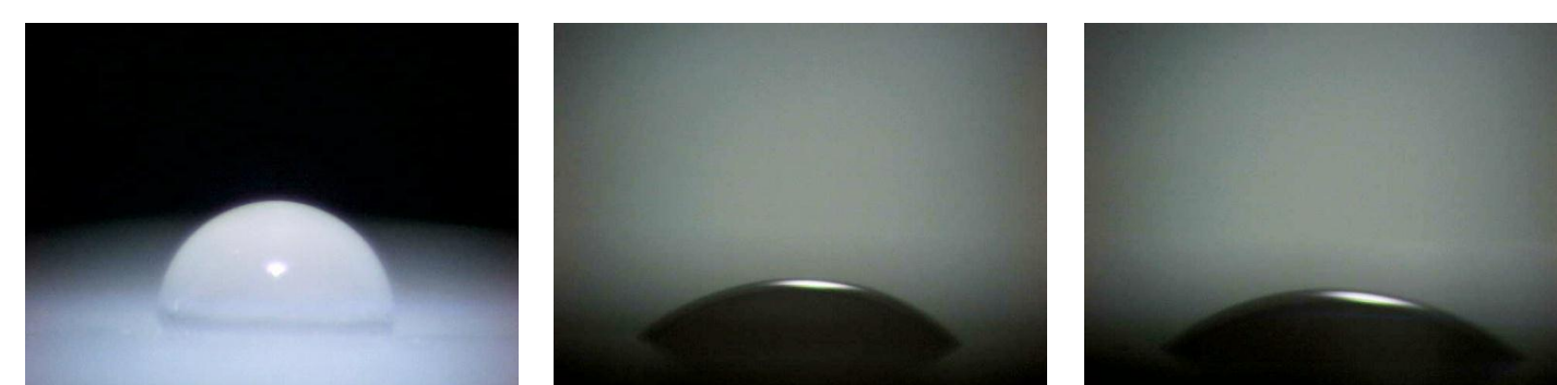
Figura 4: Fotos da variação do WCA do PEBD nos tempos de 0, 30 e 60 min após 1 dia de fotólise.
