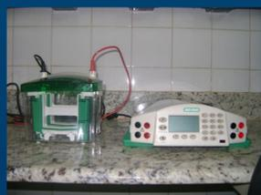
Fig. 1. Figura ilustrativa de aparelho de eletroforese.
