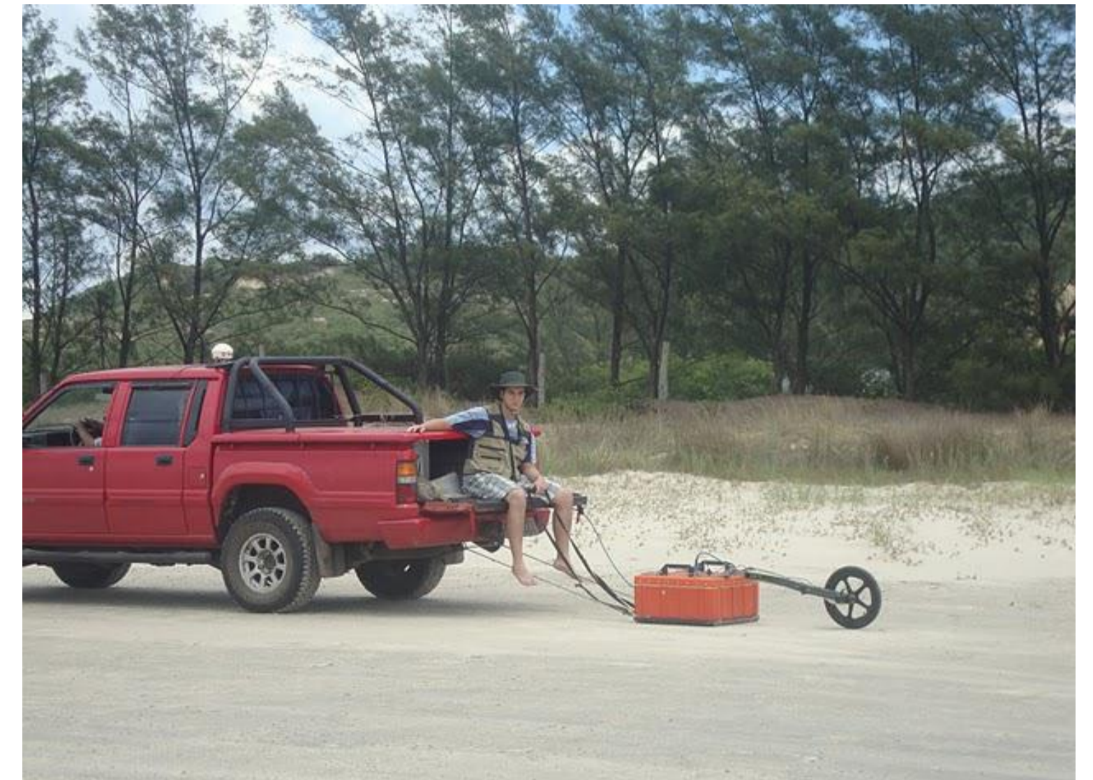
Figura 2- GPR acoplado a um veículo para viabilizar maior tamanho na linda de costa.
