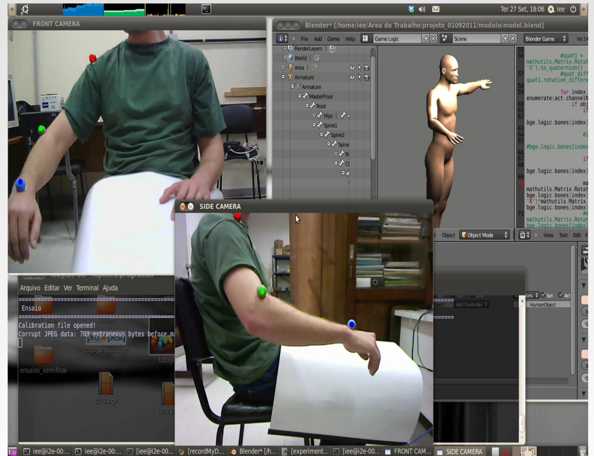
Figura 4 – Ensaio com duas câmeras e modelagem tridimensional
