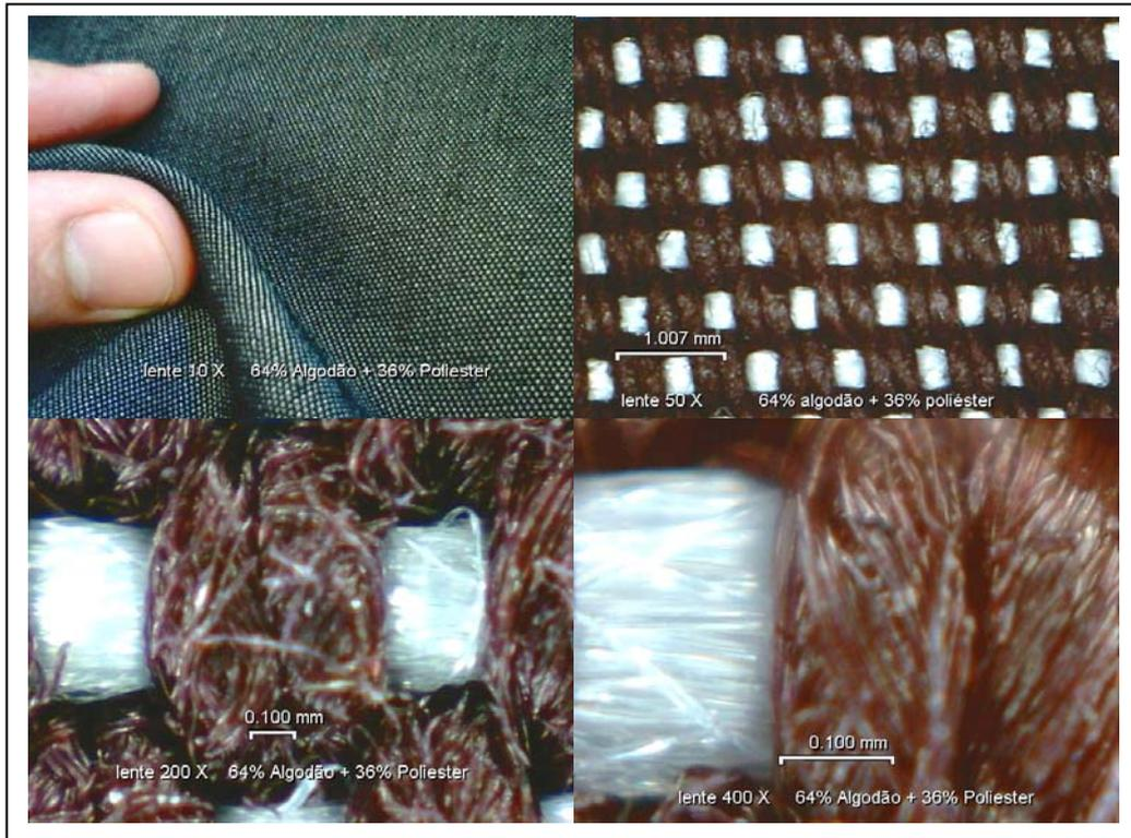
Fig. 52 - Visualização microscópica do tecido de algodão com poliéster.
