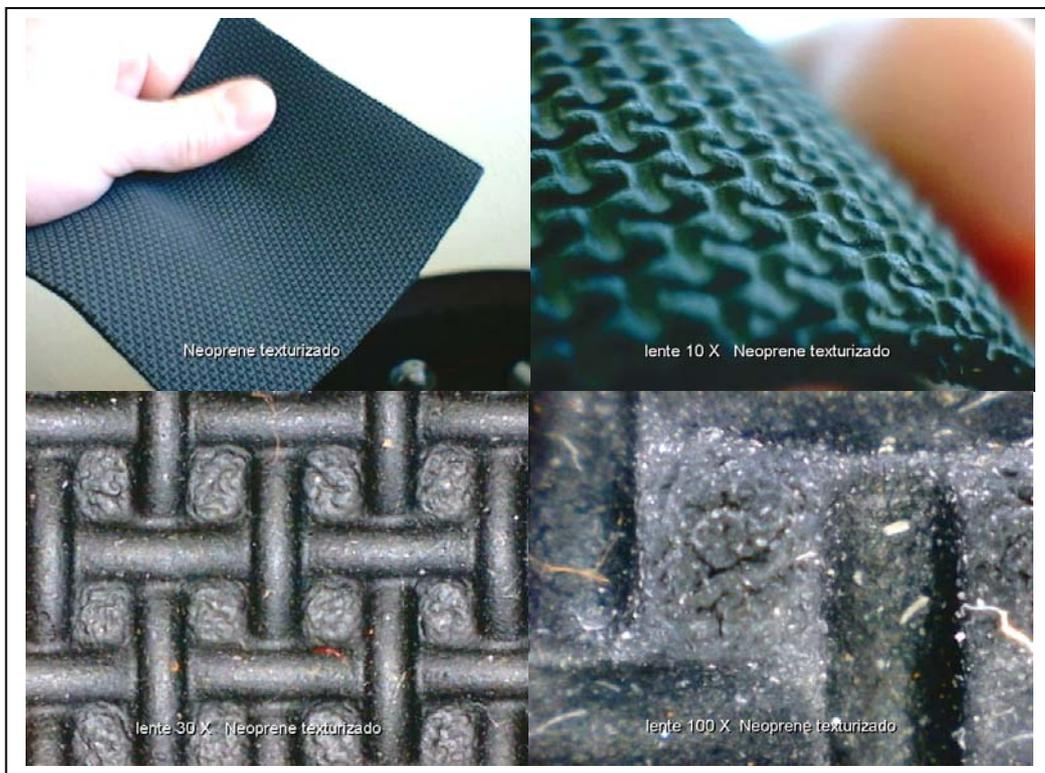
Fig. 53 - Visualização microscópica do tecido de neoprene texturizado.
