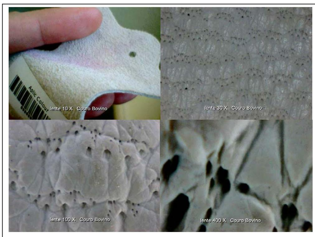
Fig. 51 - Visualização microscópica do couro bovino. Fonte: Centro de Design Feevale.
