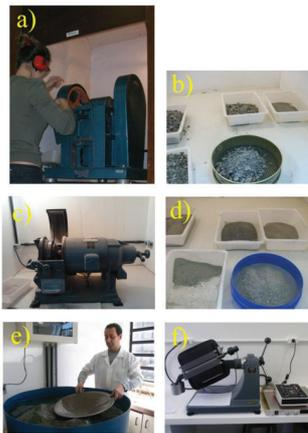
Figura 3. Etapas de preparação de amostras para obtenção dos zircões: a) Britador; b) Peneira menor que 6 mm; c) Moinho; d) Peneira menor que 500µm; e) Batéia; f) Separador magnético Frantz.
