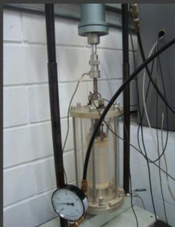
Equipamento de ensaio triaxial de módulo de resiliência
