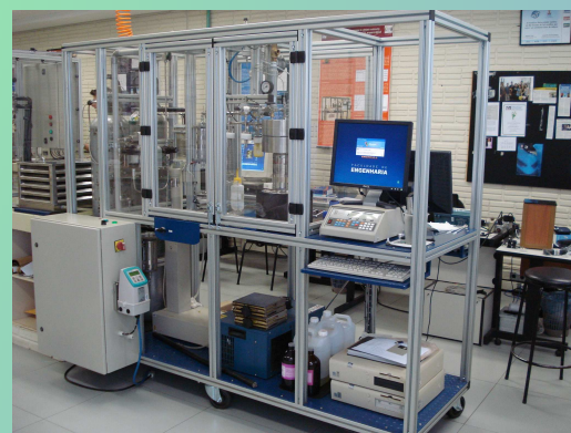
Figura 3: Unidade piloto de extração supercrítica
