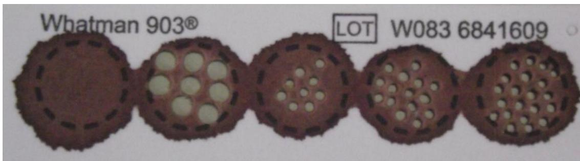
Figura 2. Cartão Whatman 903 utilizado para amostras em sangue impregnado em papel filtro. No segundo círculo, esquerda para direita, foram feitos picotes de 3 mm e nos círculos seguintes picotes de 1,2 mm.
