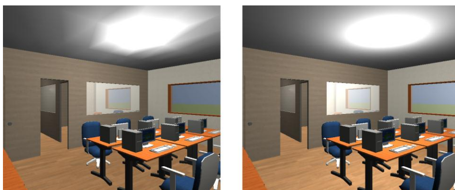
Figura 113: (a) Ambiente renderizado com vertex lighting e o mesmo ambiente renderizado com pixel lighting .
