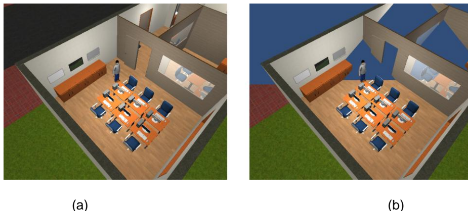
Figura 114: Uma imagem onde o frustum de renderização compreende todo o ambiente (a) e outra onde objetos mais distantes são excluídos da renderização (b).
