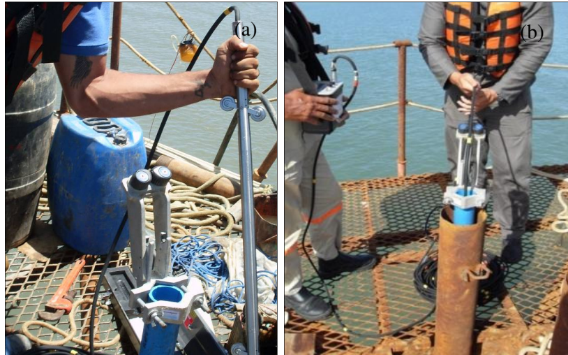
Figura 51: inclinômetro: (a) torpedo e tubo de acesso; (b) leitura sobre a plataforma
