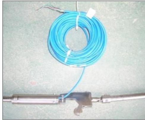
Figura 53: sensor de inclinação, cabo e rodas que compõem o inclinômetro fixo
