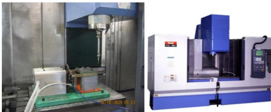
*Figura 4.10 - Máquina CNC MAZAK VTC-300C três eixos utilizada na estampagem incremental de chapas de metal. (SY, 2009)*
