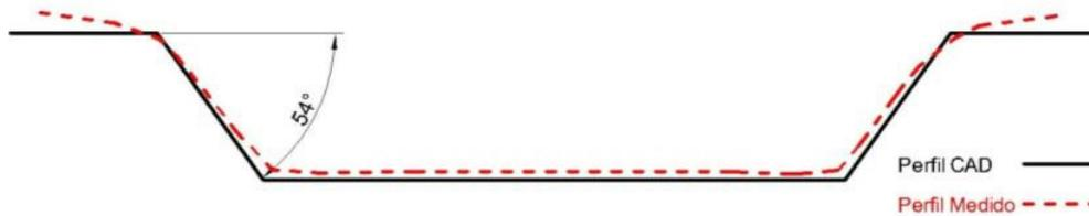
Figura 8.27: Perfil do experimento nº 6 no sentido Transversal. ( $\psi: 54^\circ \mid \Delta z: 1,00 \text{ mm} \mid$  Trajetória Paralela de Contorno)
