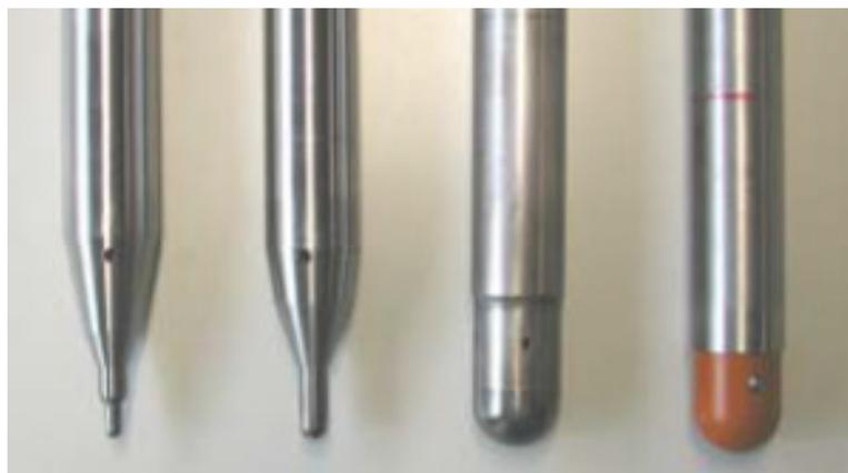
Figura 4.15: Ferramentas de metal duro com  $\varnothing 6, 10, 30$  mm, e uma ferramenta de plástico (à direita) (LAMMINEN, WADMAN, *et al.*, 2003)
