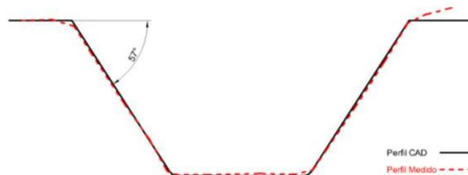
Figura 11.4: Perfil do tronco de pirâmide no sentido Transversal. ( $\psi: 57^\circ \mid \Delta_Z: 0,50 \text{ mm}$ )
