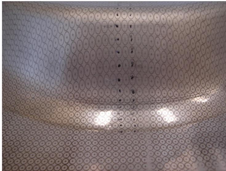
*Figura 4.23 - Exemplo de deformações em um componente estampado. (CAVALER, 2010)*
