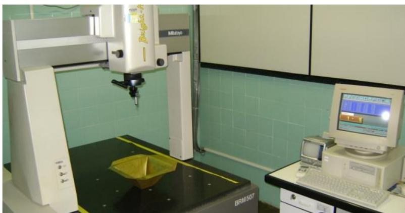
*Figura 7.7: Equipamento de medição de coordenadas.*
