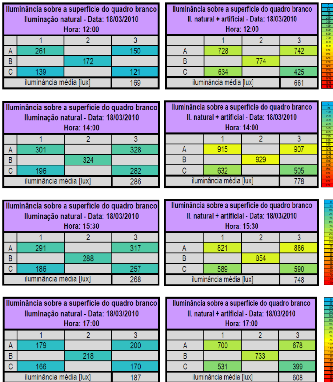
Figura 53: Iluminância sobre a superfície do quadro branco, ao longo do dia 18 de março de 2010, sob influência apenas da luz natural e desta, em conjunto com o sistema de iluminação artificial.
