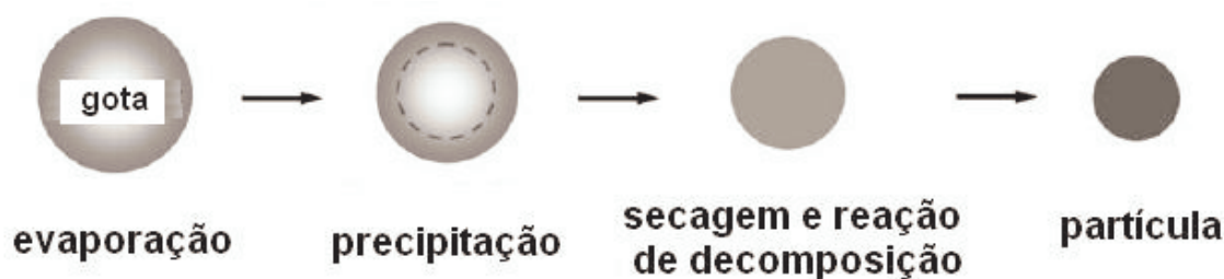
Figura 5.3. Diagrama esquemático do processo de formação das partículas esféricas observadas nos pós de ZnO (ADAPTADO de WIDIYASTUTI et al. , 2010).
