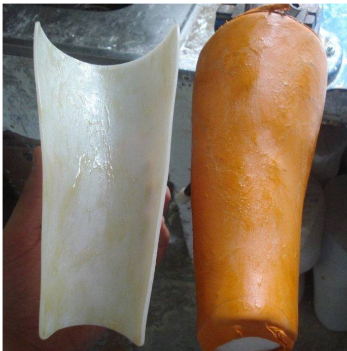
Figura 42 - Realização da colagem entre o Eva e o polipropileno
