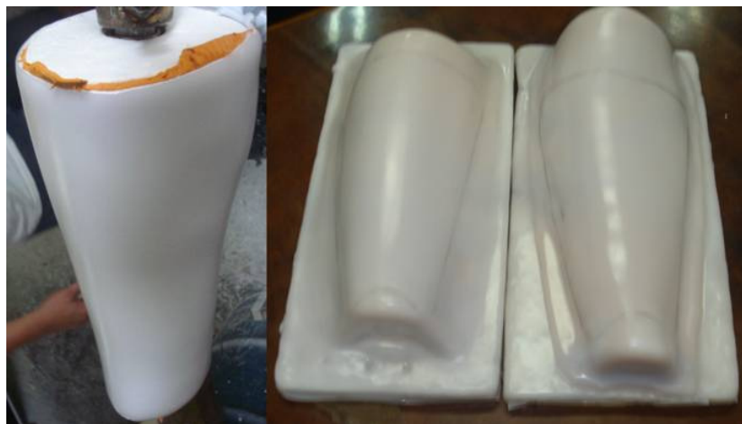
Figura 40 - Molde de gesso recebendo a camada de polipropileno a) molde em gesso e b) moldes em P.U
