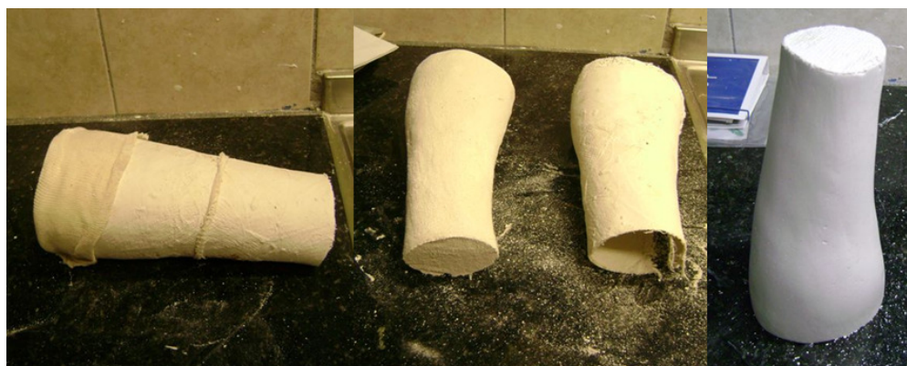
Figura 30 - Fotos do procedimento para obtenção do molde positivo de gesso
