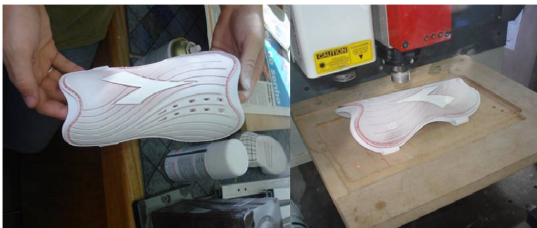
Figura 22 - Procedimento de digitalização 3D de uma caneleira, onde foi necessário alterar a cor do objeto com Spray D-70, emulsão não aquosa.
