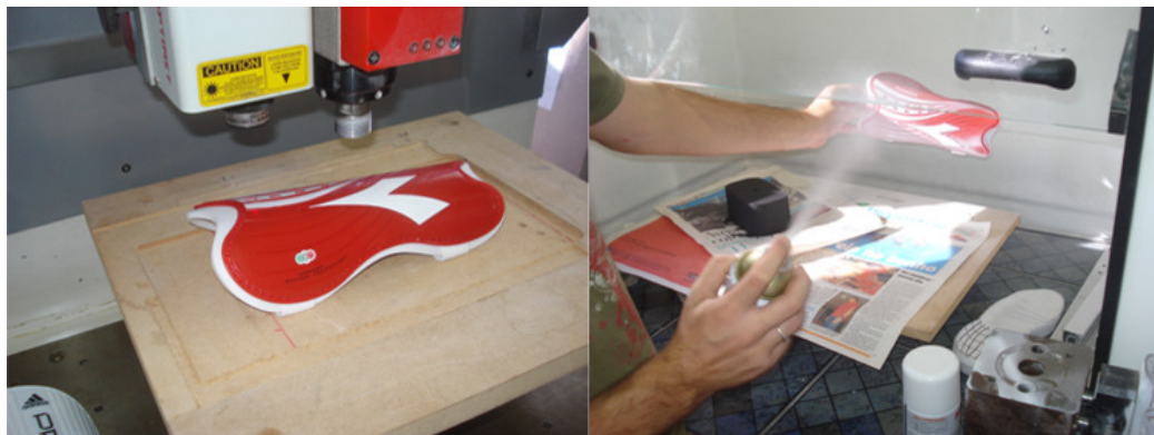
Figura 21 - a) Produto não pode ser digitalizado, por que sua cor prejudica a captação do laser pelo sensor, ocasionando dispersão do sinal b) Alteração da cor do objeto através do uso de um revelador não aquoso para aumentar a captação do laser.
