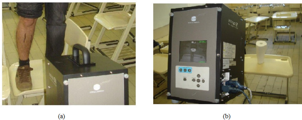
Figura 15 – a) Visualização do processo de digitalização do perfil da perna por pontos b) Processo de digitalização por pontos do molde positivo em gesso
