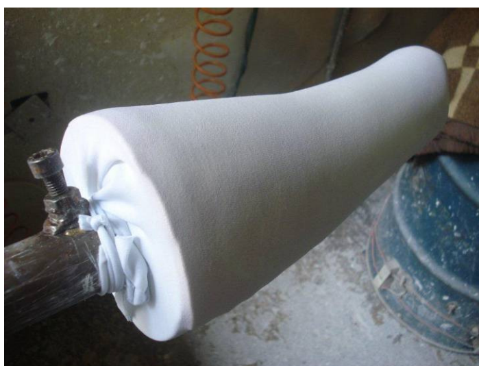
Figura 37 - Molde positivo de gesso preso no suporte e recoberto por um pano de algodão branco com espessura de 3 mm
