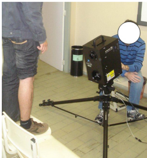
Figura 23 - Foto do procedimento da digitalização da canela de um usuário
