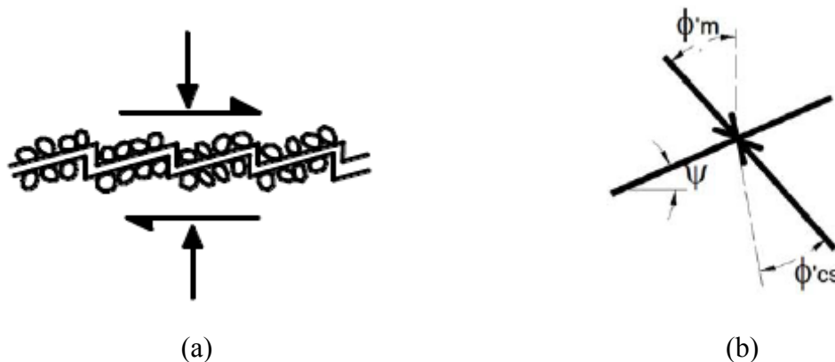
Figura 2.12: (a) Esquema de lâminas representando o intertravamento das partículas de solo; (b) Forças resultantes. (adaptado de WOOD, 1990)
