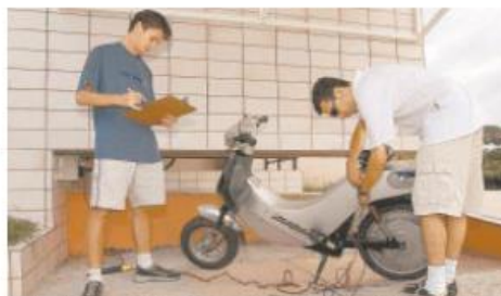
Enchendo o tanque: abastecimento a partir de baterias alimentadas por raios de sol
