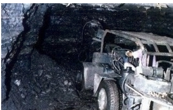
Operação 3: Perfuratriz de Frente.
