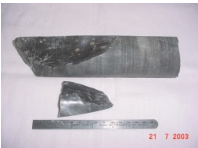
Figura 5.9 – Fratura Natural com Slickenside do Pedaco 23 do Pilar 2.
