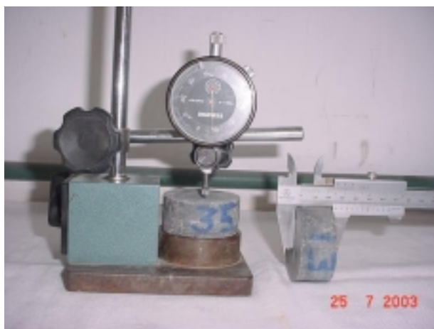
Figura 5.29 – Verificação do Paralelismo das Faces do CP (Laboratório de mecânica de rochas da UFRGS, 2003).
