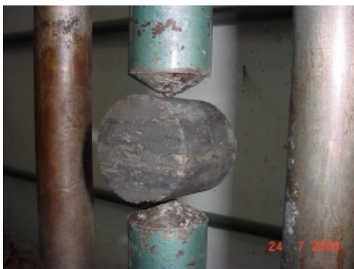
Figura 5.23 – Exemplo da Orientação da Carga num Ensaio Diametral de Carga Pontual em Relação aos Planos de Sedimentação observados no CP. (a) Esquema de Carregamento, (b) Corpo de Prova sendo Ensaiado.
