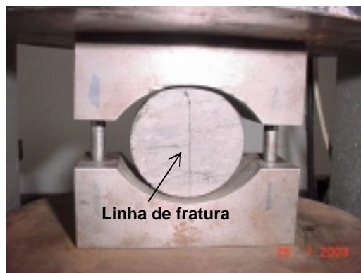
Figure 4.7 – Fratura ao Longo da Direção Diametral de Carregamento (Laboratório de Mecânica de Rochas da Universidade Federal do Rio Grande do Sul (UFRGS), 2003).
