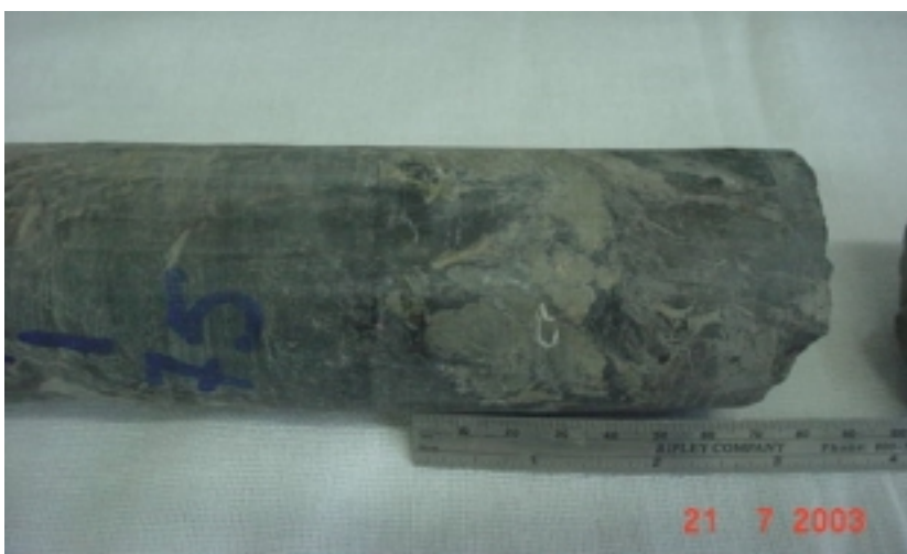
Figura 5.10 – Concreções de Pirita do Pedaco 20 do Pilar 1.
