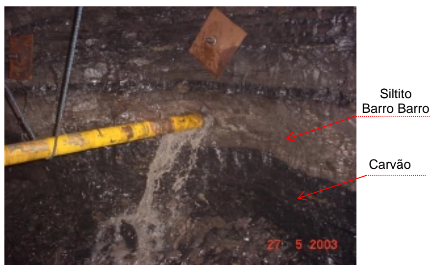
Figura 5.2 – Barrilete Duplo durante a Sondagem Horizontal no Estrato Siltito Barro Branco.
