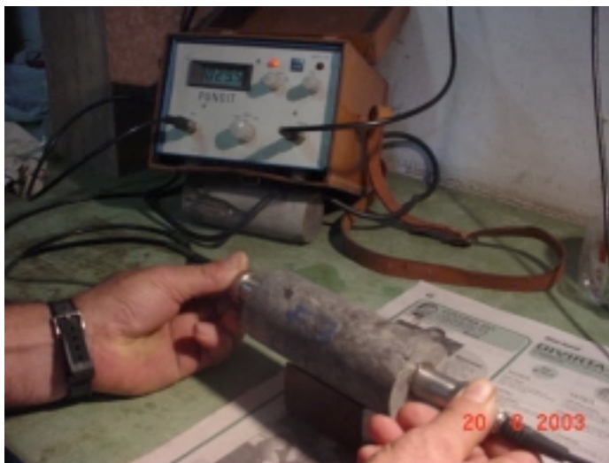
Figura 5.42 – Posicionamento do CP no Suporte de Bancada e Acoplamento dos Transdutores de Frequência (Laboratório de Mecânica de Rochas do CIENTEC, 2003).
