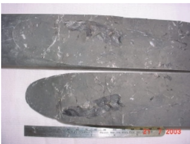
Figura 5.11 – Fratura Natural (com Fóssil no Plano da Fratura) do Pedaco 13 do Pilar 3.
