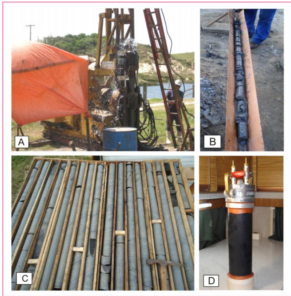
Figura 9. A) Sondagem do tipo rotativo a diamante. B) Lavagem das amostras. C) Armazenagem dos testemunhos de rocha em caixas. D) Cilindro de PVC com 36 cm de comprimento e 7 cm de diâmetro, utilizados para a medida do gás metano em desorção nas amostras de carvão.
