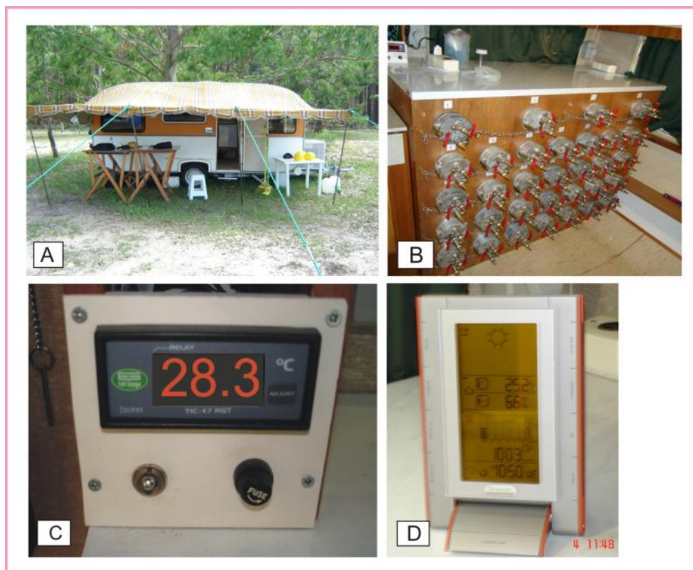
Figura 11. A) Laboratório móvel ( trailer ). B) Caixa contendo os cilindros. C) Termômetro acoplado para controle da temperatura interna da caixa. D) Aparelho para monitoramento da pressão e temperatura ambiente.
