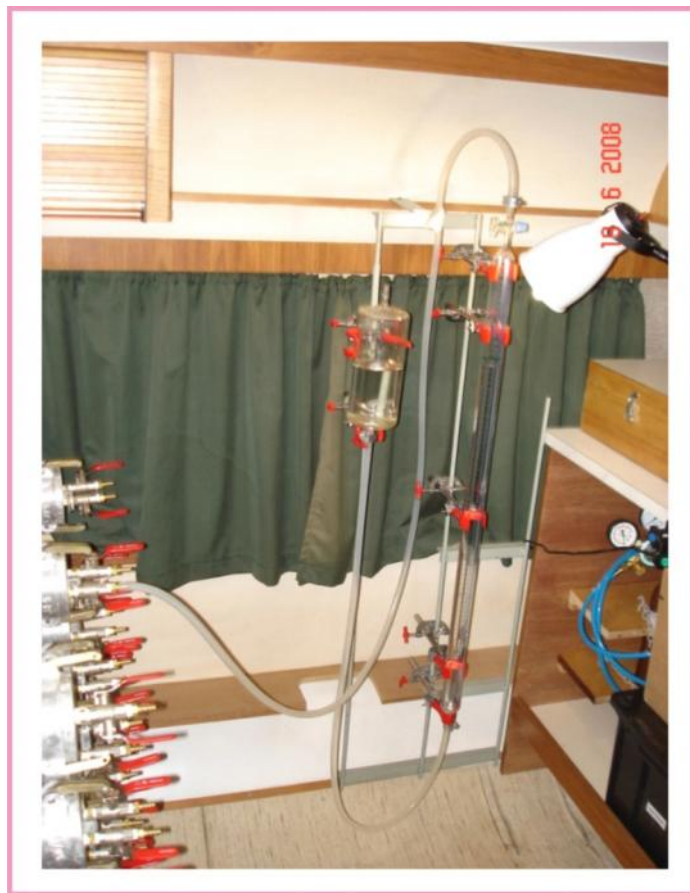
Figura 12. Coluna de vidro graduada ( \text{mm}^3 ) e reservatório de água em vidro borossilicatado utilizado para a medição do volume de gás metano em desorção dos cilindros.
