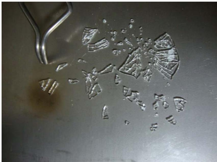
Figura 10: Quench da composição de diopsídio vertido na chapa de inox.
