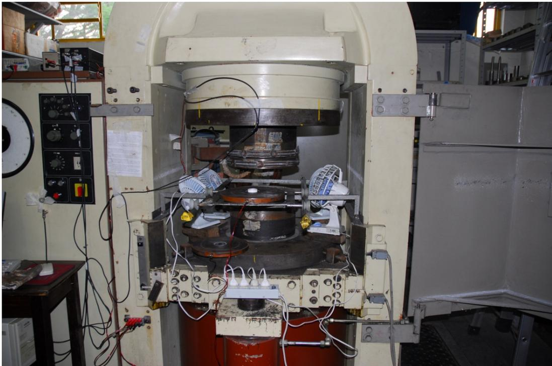
Figura 15: Prensa hidráulica de 1000 tonf do LAPMA.
