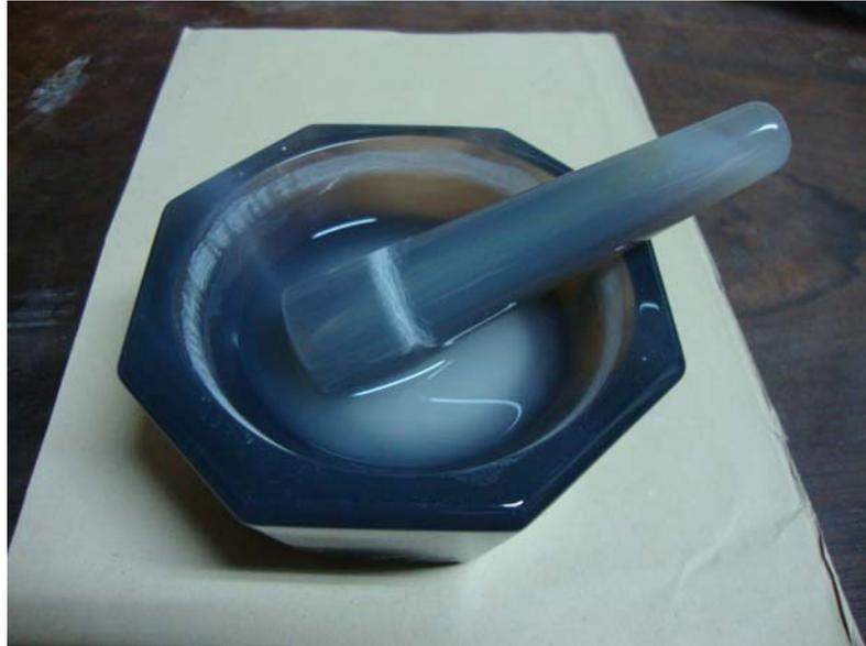
Figura 12: Homogeneização em gral das composições feitas a partir da mistura dos vidros em acetona.
