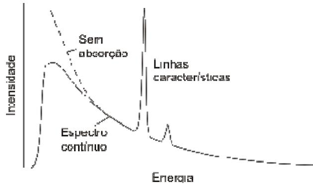
Figura 26: Espectro gerado a partir de bombardeamento com feixe de elétrons, onde é emitido um espectro contínuo, devido a desaceleração dos elétrons, e outro em linhas, que é característico de cada elemento. Fonte: Reed, 1996.
