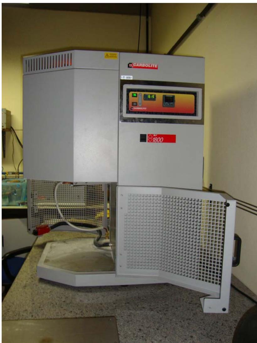
Figura 11: Forno utilizado para confecção dos vidros.
