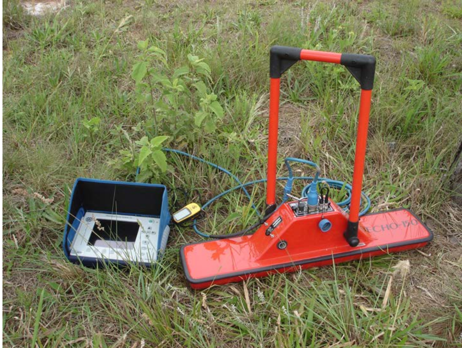
Figura 2. Antena utilizada na aquisição dos dados neste estudo: composta por uma caixa blindada (vermelha) a qual possui, internamente, uma antena transmissora e outra receptora. Os dados digitalizados são armazenados na memória do coletor (azul) conectado a um GPS (amarelo).
