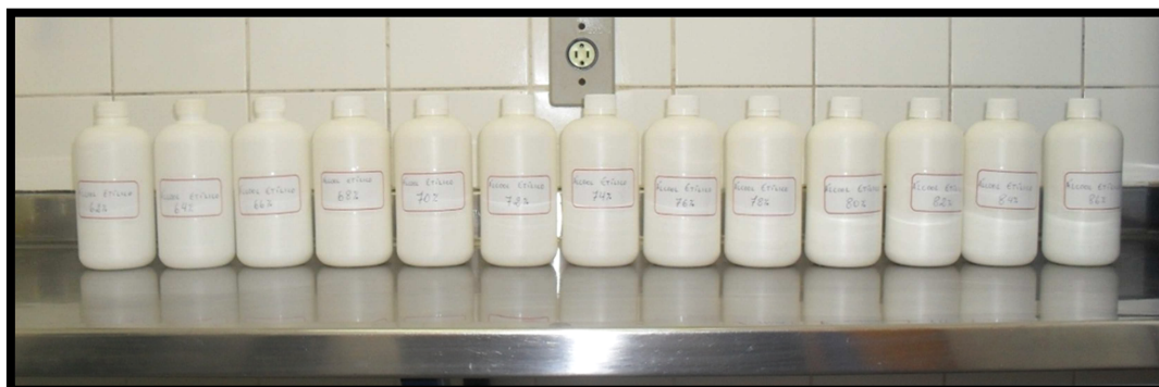
Figura 5 – Concentrações de álcool utilizadas para o teste de instabilidade do leite (62 a 86°GL).
