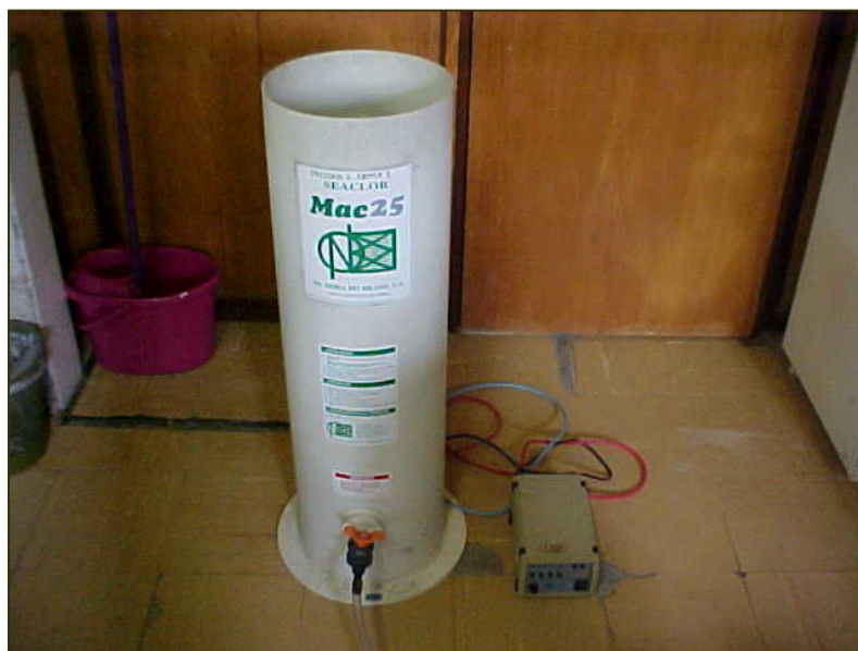
Fig 4.5: Detalhe do equipamento gerador de hipoclorito.
