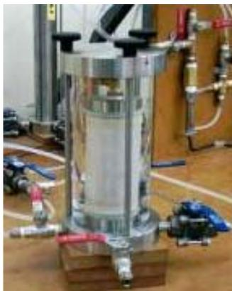
Figura 3.13 – Câmara triaxial de pressão com a amostra de solo instalada.
