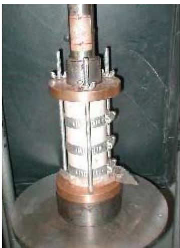
Figura 3.5- Moldagem de corpos de prova.
