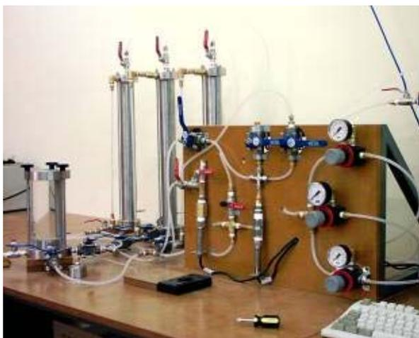
Figura 3.8 – Permeâmetro de Parede Flexível desenvolvido no ENVIRONGEO/ UFRGS.
