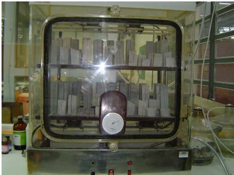
Figura 4.12: Vista frontal da câmara saturada de CO<sub>2</sub>
