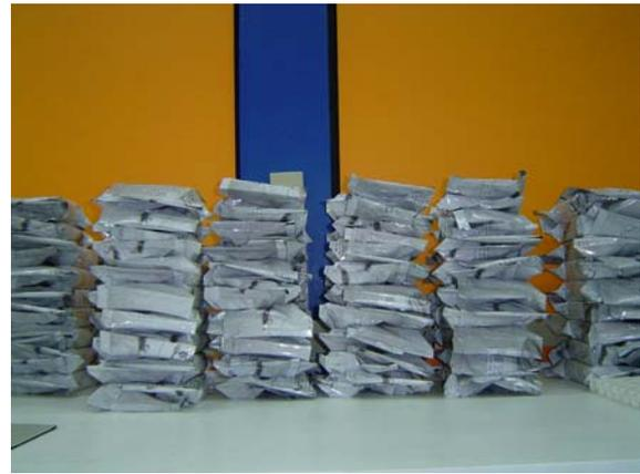
Figura 4.5: Corpos-de-prova em fase de redistribuição da umidade na sala climatizada
