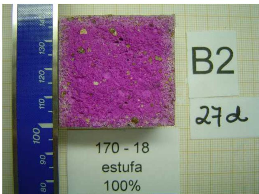
Figura 5.2: Amostra em que a frente de carbonatação não é bem definida
