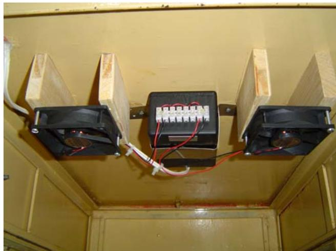
Figura 4.9: Ventiladores da parte superior da câmara de 6% de CO<sub>2</sub>
