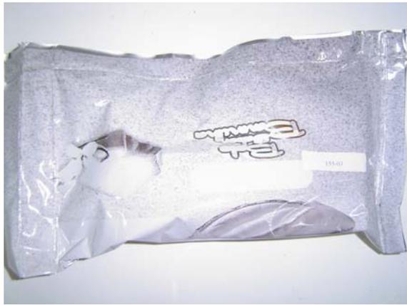
Figura 4.4: Corpo-de-prova embalado após equilíbrio da umidade na sala climatizada
