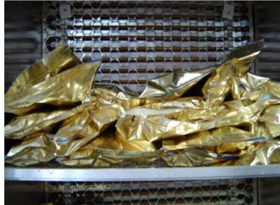
Figura 4.8: Corpos-de-prova em fase de redistribuição da umidade na estufa
