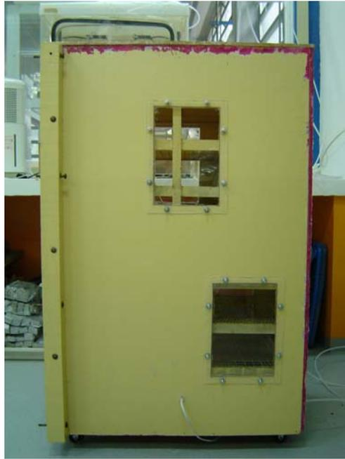
Figura 4.11: Vista lateral da câmara de 6% de CO<sub>2</sub>
