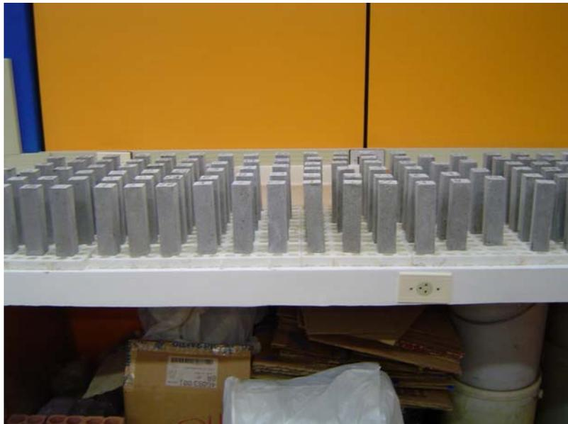
Figura 4.3: Disposição das amostras para secagem na sala climatizada
