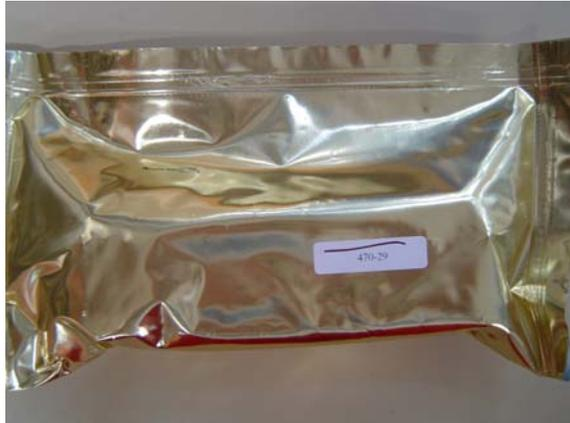
Figura 4.7: Corpo-de-prova embalado após atingir perda de massa desejada na estufa
