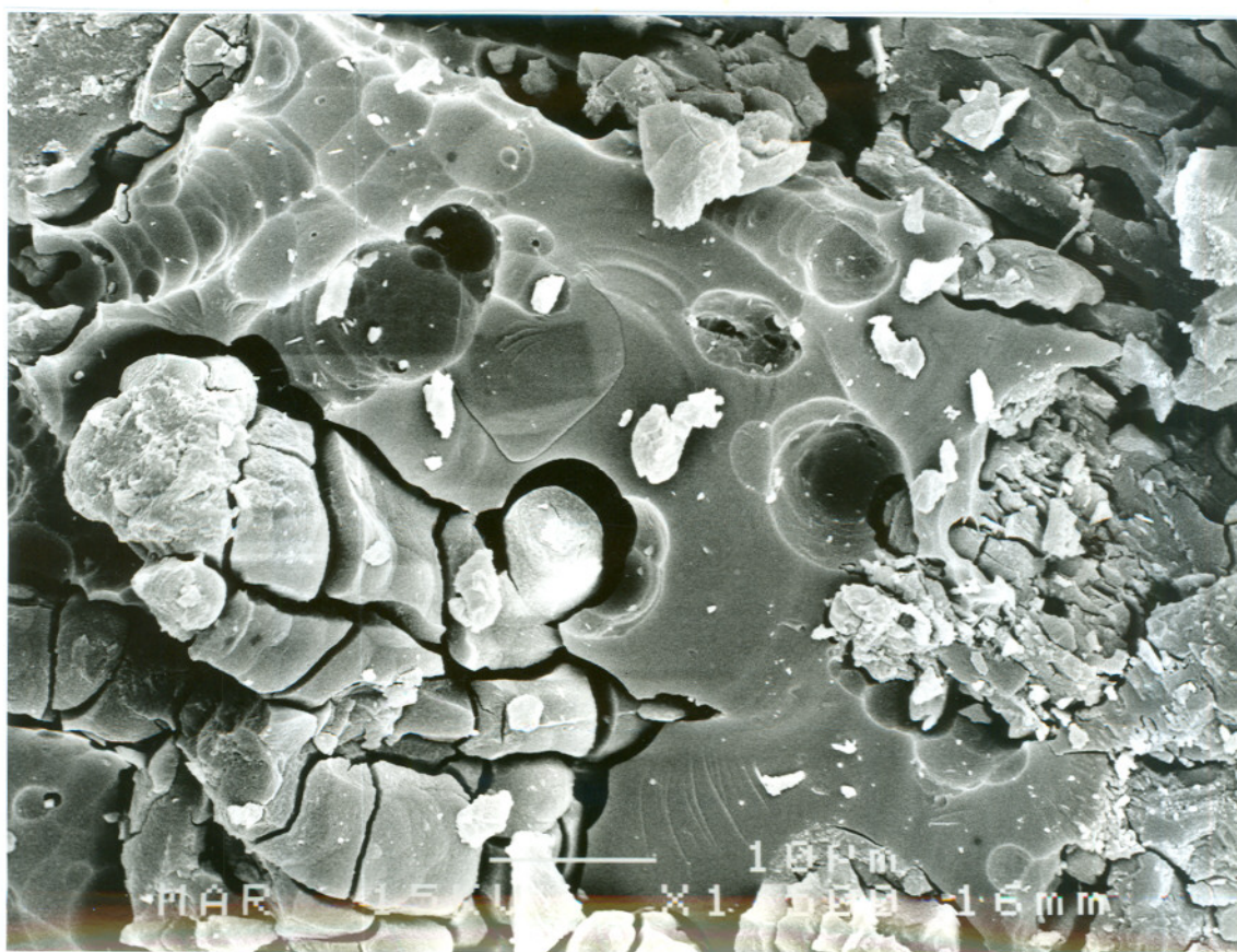
FOTO 37. Ao MEV os materiais intersticiais apresentam aspecto dos vidros vulcânicos: superfícies suavemente curvas com pequenas vesículas, fraturas conchoidais, figuras de dissolução esféricas. 1500x.
