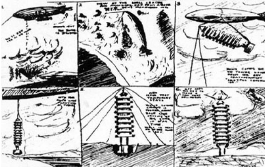
11. Richard Buckminster Fuller, 1927. Instalação e transporte de uma torre executada em estrutura metálica (torre 4-D, precursora do projetos Dymaxion).
