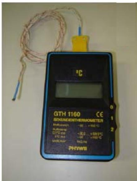
Figura 18 - Dispositivo de aferição de temperatura (*Sekundenthermometer GTH 1160- PHYWE*).
