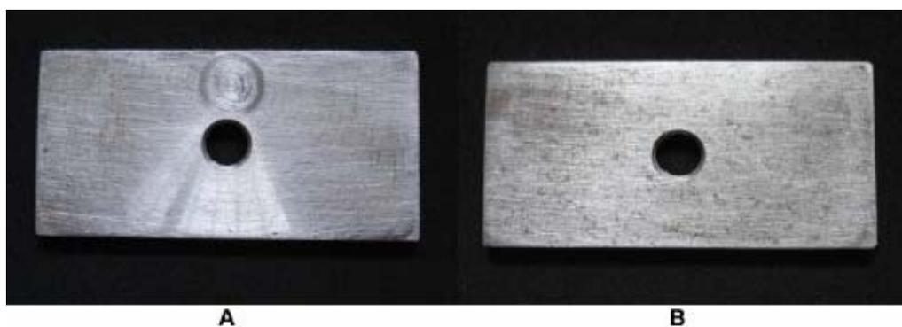
Figura 10 - Placa metálica, obliteratedora e distanciadora, com orifício . A- Sinalização na parte superior da placa indica o lado de inserção da matriz. B- Lado de inserção do condutor de luz do fotopolimerizador.
