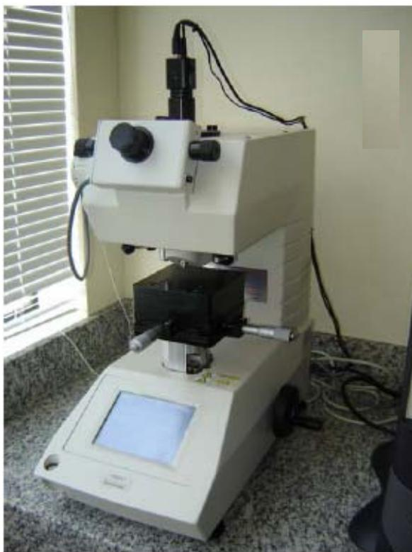
Figura 16 - Aparelho *Micro Hardness Tester* HMV (*Shimadzu*-Japão).
