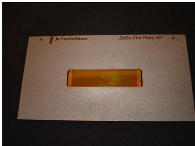
**Figura 14 - Placa de cristal do acessório ATR.
