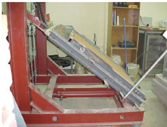
Figura 4.6 – Conclusão do ensaio de rampa de interface solo-geotêxtil.
