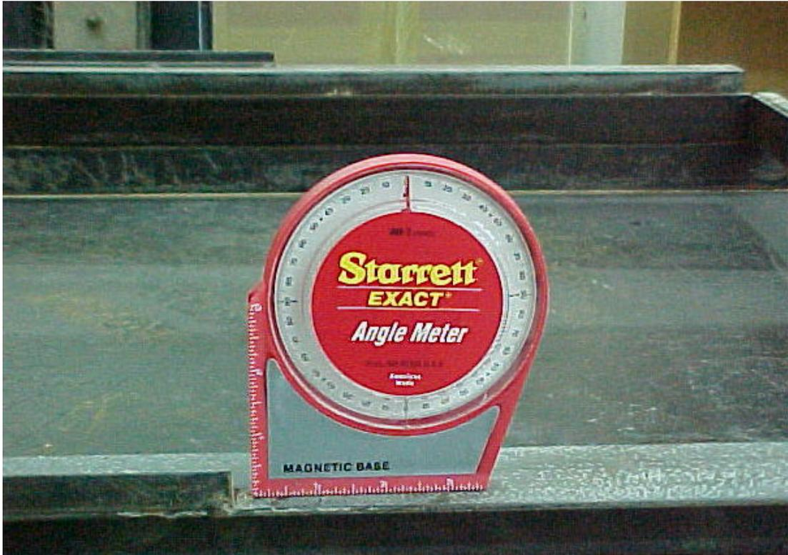
Figura 3.11 – Medidor de ângulo de rampa de base magnética.
