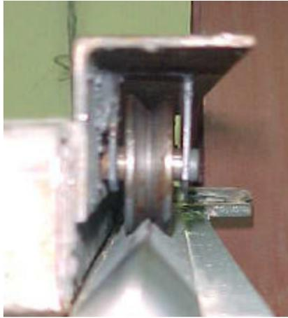
Figura 3.9 – Detalhe da roldana da caixa superior sobre o trilho da caixa inferior.
