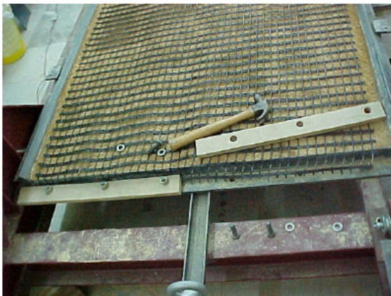
Figura 4.4 – Instalação da amostra de geogrelha na preparação do ensaio de rampa.
