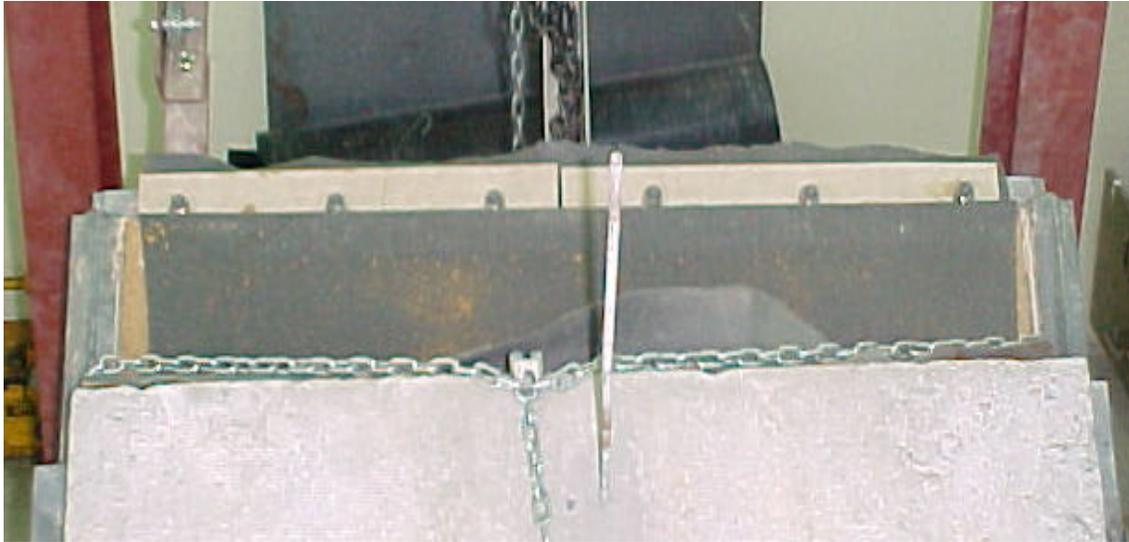
Figura 4.20 – Estricção da amostra de geotêxtil após o ensaio ( $\sigma_c = 4,6\text{kPa}$ ).
