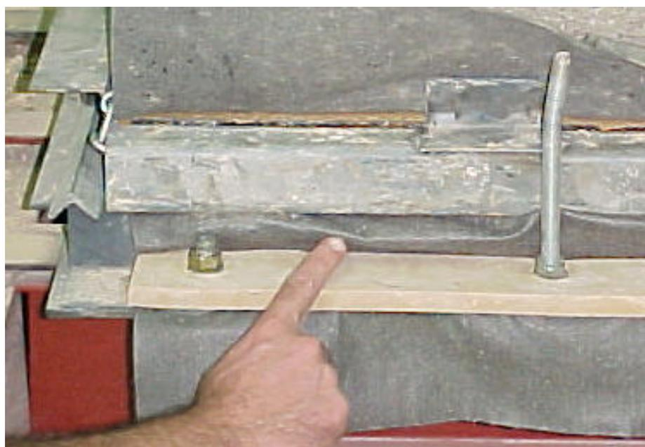
Figura 4.19 – Enrugamento da amostra de geotêxtil após o ensaio ( $\sigma_c = 4,6\text{kPa}$ ).
