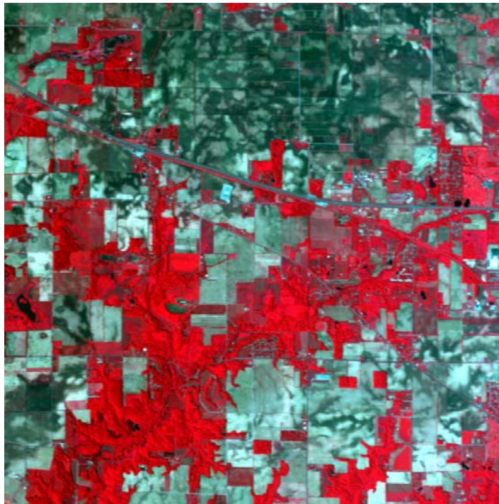
Fig. 28 - AVIRIS: Composição RGB com as bandas 50, 27 e 17, da área experimental de teste, ( NW Indiana's Indian Pine) - 220 bandas espectrais
