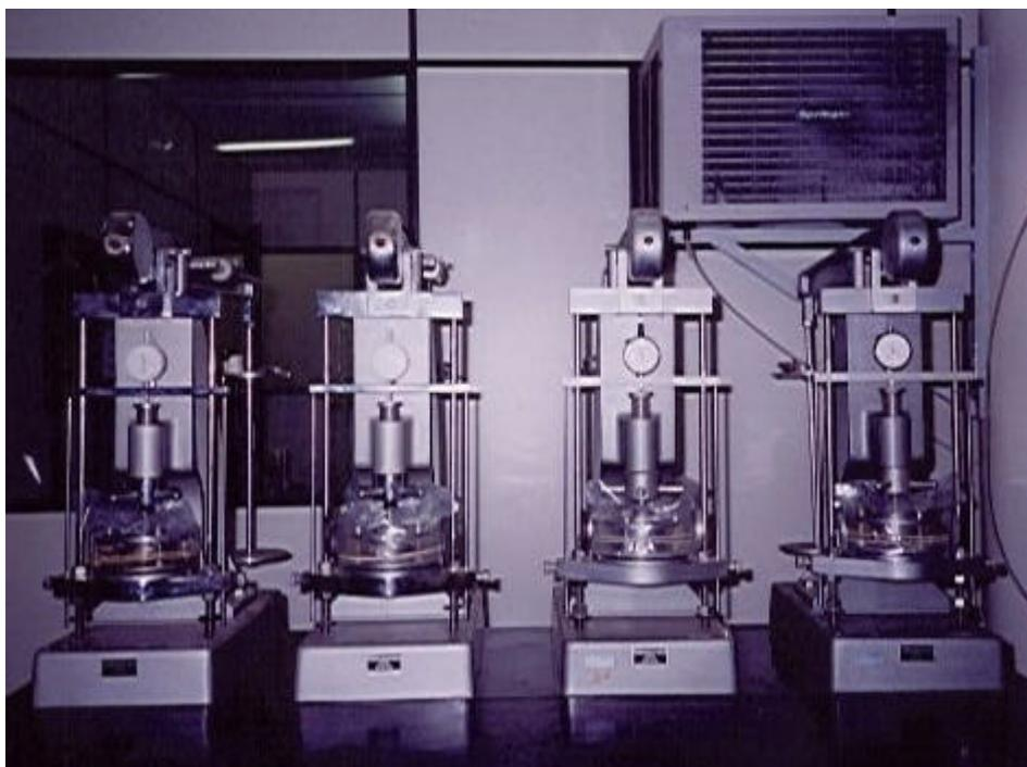
**Figura 3.4 – Vista frontal do equipamento oedométrico convencional**
