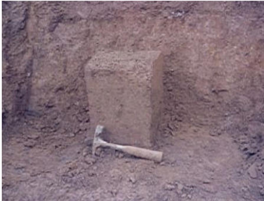
**Figura 3.1 – Bloco indeformado com o topo e as laterais esculpadas**
