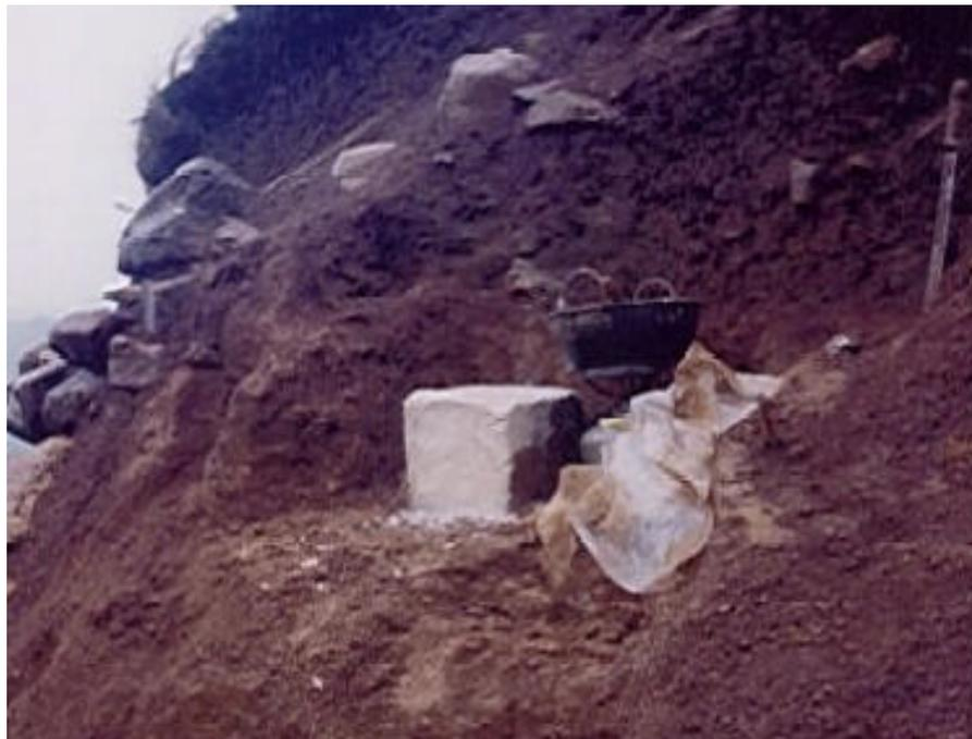
**Figura 3.2 – Bloco indeformado sendo parafinado**
