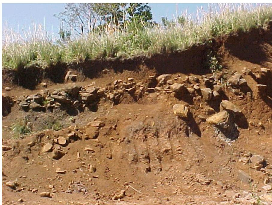
**Figura 4.5 – Perfil de Solo Litólico, em duas seqüências de colúvio sobre solo residual de basalto (próximo ao km 1000 do Gasoduto)**
