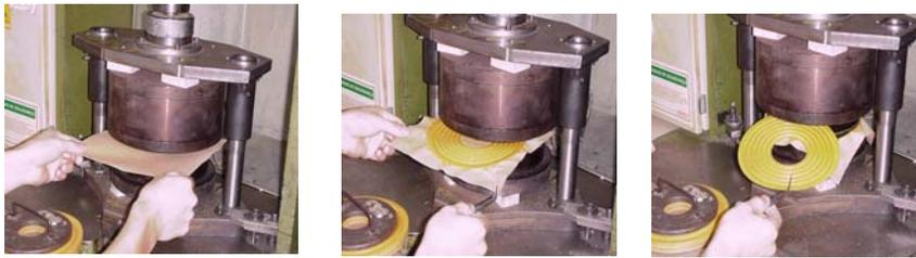
Figura 16 - Moldagem de um anel de centragem
