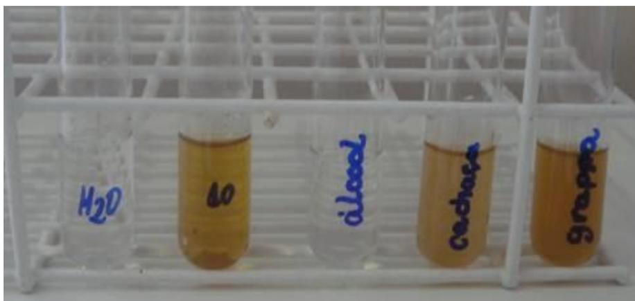
**Figura 10** - Amostras após a adição da solução de dietilditiocarbamato de sódio 0,2%
