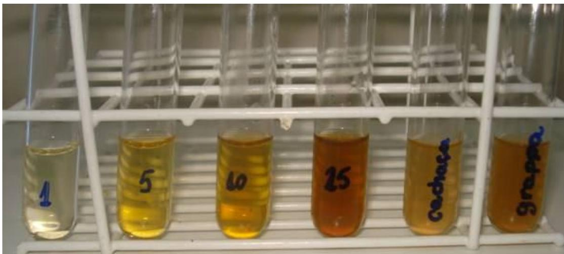
**Figura 11** - Soluções de Cobre contendo 1, 5, 10 e 25 mg.L<sup>-1</sup>, cachaça e grapa após a adição da solução de dietilditiocarbamato de sódio 0,2%
