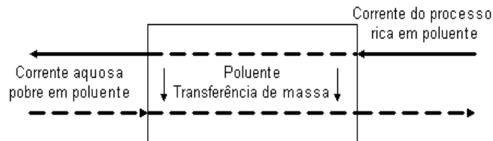
Figura 2.6: Unidades de sistemas de água segundo a tecnologia pinch .
