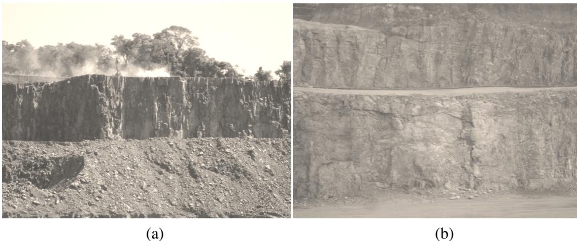
Figura 7 - Bancada de extração de rocha (a) basáltica em Montenegro (b) e granítica em Eldorado do Sul
